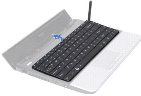
6. Sollevare la tastiera fino a quando il connettore del cavo della tastiera non è visibile.
